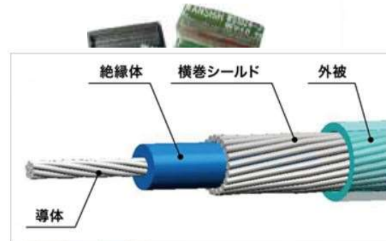
▲極細同軸ケーブルの構造
